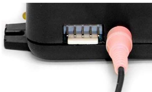
Корпус разъема соединен с сигнальной землей, концевой контакт соединен с цепью микрофонной цепи.
