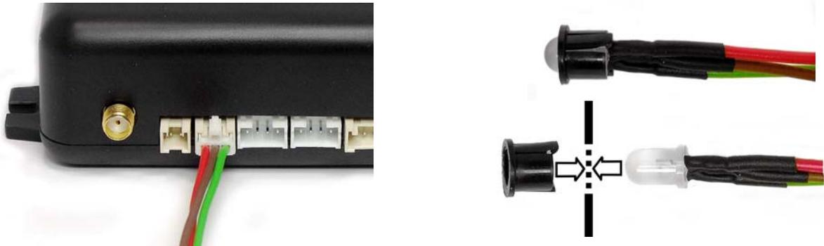
При необходимости скрытой установки системы обратите внимание на выбор места установки светодиода. Либо монтируйте его в месте, где он не будет виден снаружи автомобиля (например, внутри бардачка), либо не устанавливайте его вовсе.
