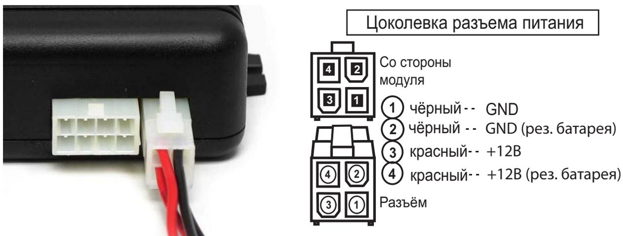
**Для подключения основного питания** (к бортовой сети автомобиля) используются красный и черный провода кабеля питания.
